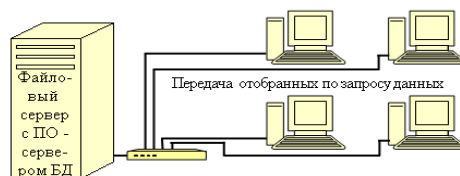
Рис. 2. Схема работы с БД в архитектуре "Клиент-сервер"
