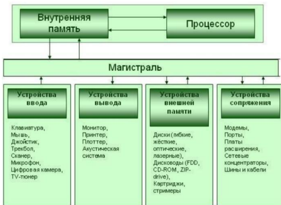
Рисунок 2. Магистрально – модульный принцип
