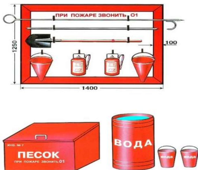
Рисунок 6 - Пожарный щит первичных средств пожаротушения
